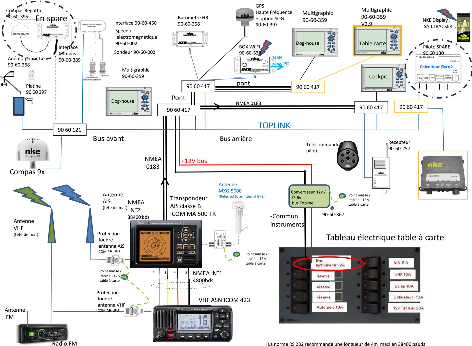
! La norme RS 232 recommande une longueur de 4m maxi en 38400 bauds
